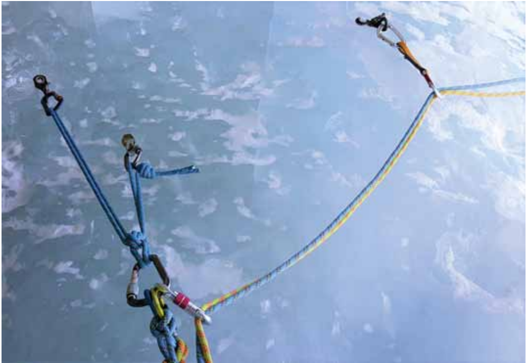
Figura 3: corretta configurazione della "sosta" in caso di assicurazione ventrale, con pseudo-rinvio al vertice e primo ancoraggio di protezione.
