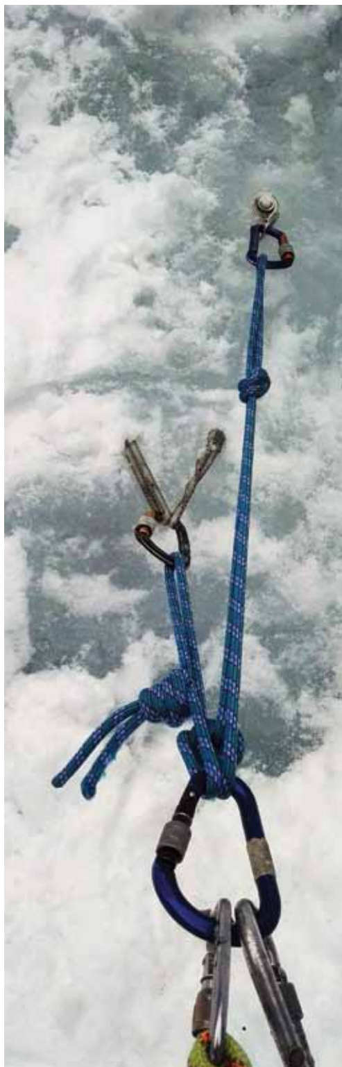
Figura 4: particolare della "sosta fissa bilanciata" con nodo semplice su un ramo di collegamento.
