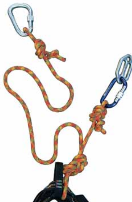
Figura 5: longe di calata con spezzone di corda dinamico.
